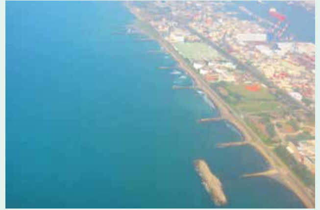
從飛機要降落小港機場前，可以俯瞰旗津沙灘滿佈離岸消波塊奇觀，很明顯改變海岸地形，失去自然景觀。
