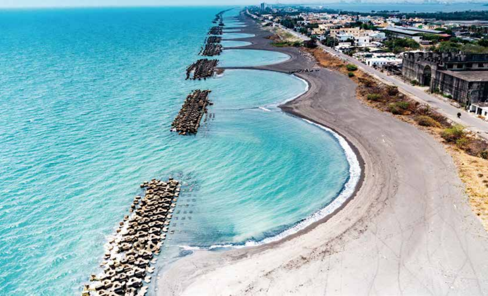
離岸淺堤消波塊造成海邊沙灘U形灣，非常容易形成離岸流(裂流)，這是海邊游泳者的隱形殺手。(曹杰/空拍)
